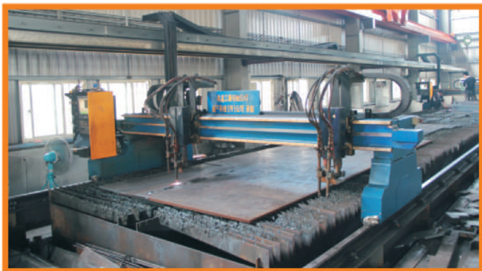
火焰、電離子切割機
